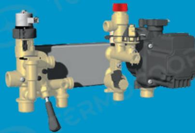
Gruppo idraulico compatto in ottone. Gruppo di mandata con deviatrice motorizzata, by-pass e rubinetto di carico impianto integrati. Circolatore ERP con sblocco pompa manuale su gruppo di ritorno.
